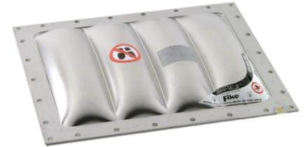
Die leistungsstarken Sani-V-S™-Explosionsdruckentlastungen von Fike für Clean-in-Place-/Steam-in-Place-Anwendungen sind mit einer leichten Konstruktion, einer einzelnen, mehrfach gewölbten Membran, einem integrierten oberen Rahmen und einer im Rahmen abgedichteten Berstlinie ausgestattet. Im Vergleich zur flachen Sani-V hat die gewölbte Sani-V-S eine höhere Vakuumbeständigkeit.
