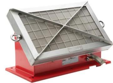
EleQuench von Fike ist eine flammenlose Entlastungsvorrichtung für Becherwerke, die eine konventionelle Druckentlastung in Innen- und Außenbereichen ermöglicht. Die Technologie besteht aus verschiedenen Schichten von Hochtemperatur-Edelstahldrahtgeflecht, die die bei der Verbrennung entstehende Wärme absorbieren und die Staubpartikel zurückhalten, so dass keine Flamme und nur geringe Staubpartikel freigesetzt werden.
